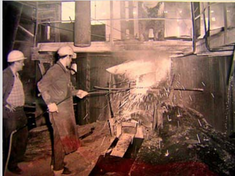
Abstich des Rohsteins
